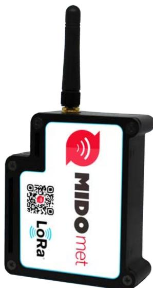
MiDoMet LoRa Pulse è un innovativo modulo radio per la telelettura di contatori di acqua, gas, luce e calore. Interoperabile con qualsiasi rete LoRaWAN, la rete (LPWAN) a lungo raggio e a basso consumo che consente lo sviluppo economico e semplice delle applicazioni Internet of Things.
