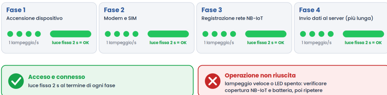
Figura 8 – Accensione: 7 lampeggi con calamita ferma e sequenza automatica
