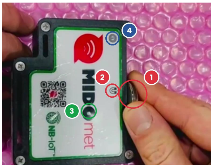
Figura 7 – Posizione della calamita, del LED e dell'area NFC
