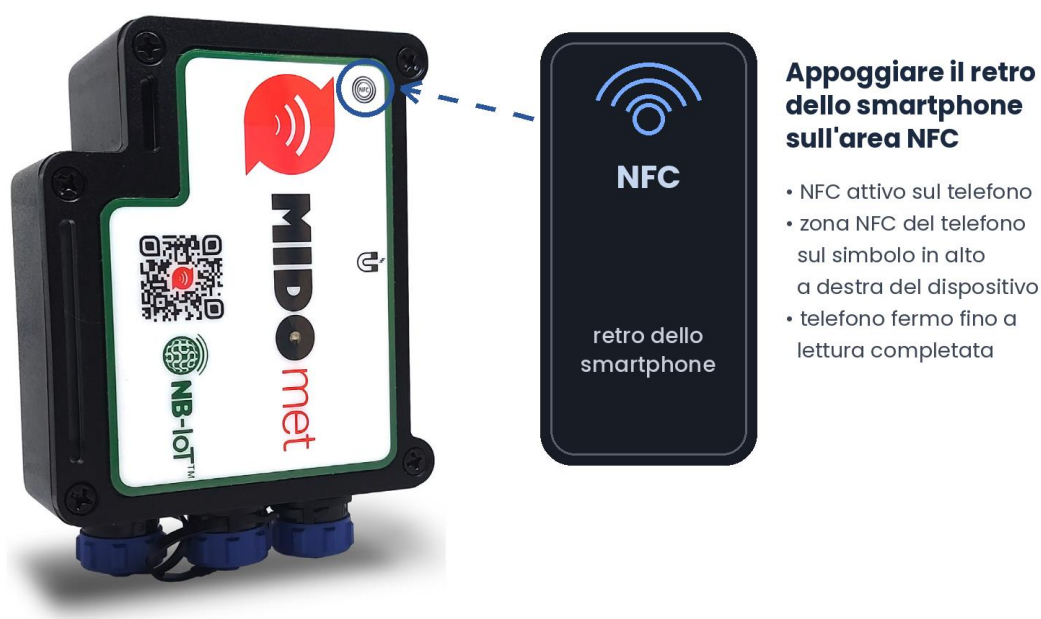
Figura 12 – Posizione dello smartphone sull'area NFC
