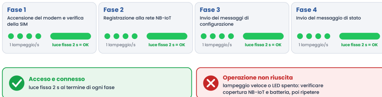
Figura 11 – Accensione: 7 lampeggi con calamita ferma e sequenza automatica
