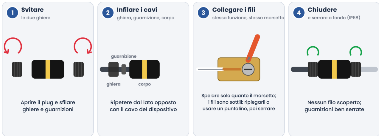
Figura 9 - Montaggio del plug di giunzione
