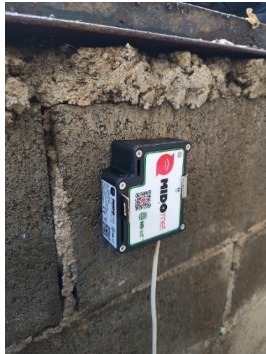
Figura 13 – Dispositivo installato a parete, con i connettori rivolti verso il basso
