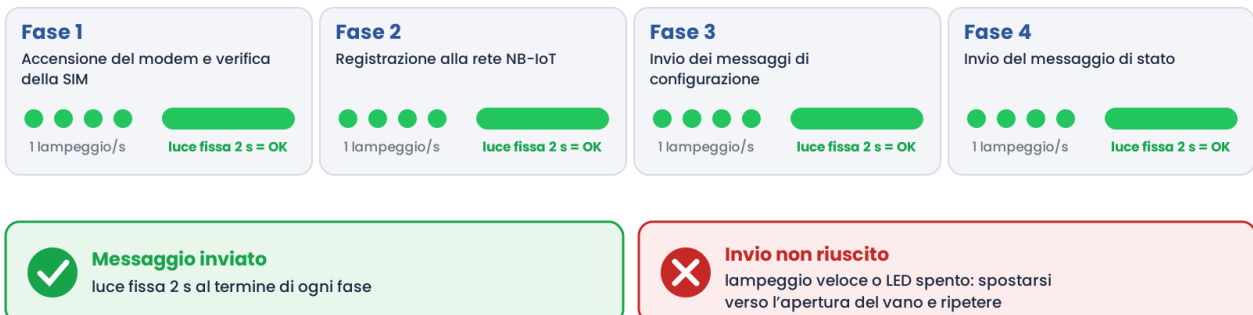
Figura 14 – Messaggio di stato: 3 lampeggi e sequenza di invio
