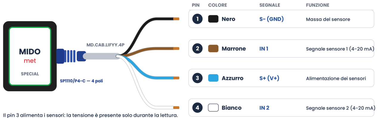
Figura 7 - Colori e funzioni del cavo degli ingressi analogici
