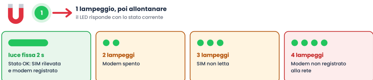
Figura 15 – Risposte del LED al singolo lampeggio
